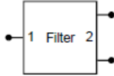
図3 シングルエンド・ポートとバランス・ポートのあるフィルタ
