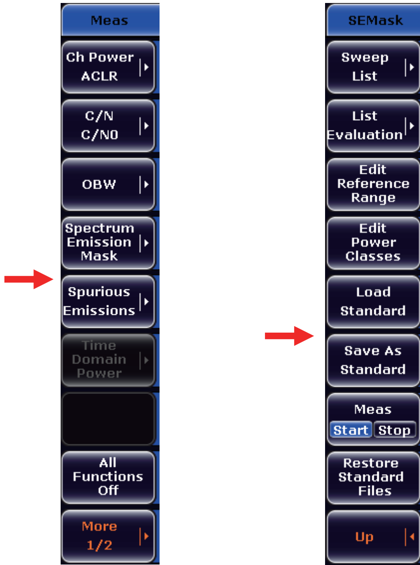
図 15: R&S®FSV スペクトラム・アナライザ・モードにおける SEM 選択メニュー
